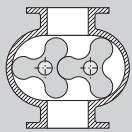
Compresor rotativo de émbolos lobulares / Funcionamiento en calidad de compresor
