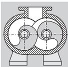
Druckstoßfeste Schrauben-Vakuumpumpe zum Ansaugen von explosionsfähiger Atmosphäre aus Zone 0
