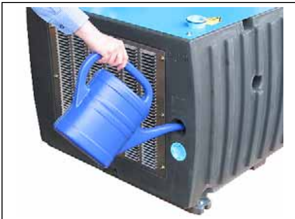
Fig. 8: Abscheider füllen Typen 2BL2 251 - 341 (über die Einfüllöffnung)
