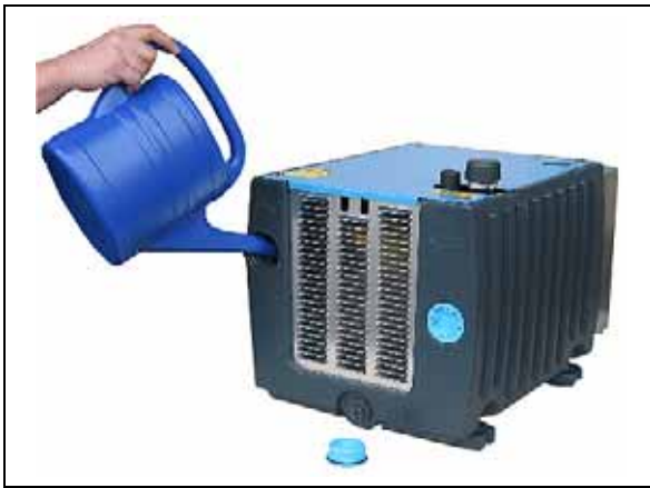
Fig. 7: Abscheider füllen Typen 2BL2 041 - 141 (über die Einfüllöffnung)
