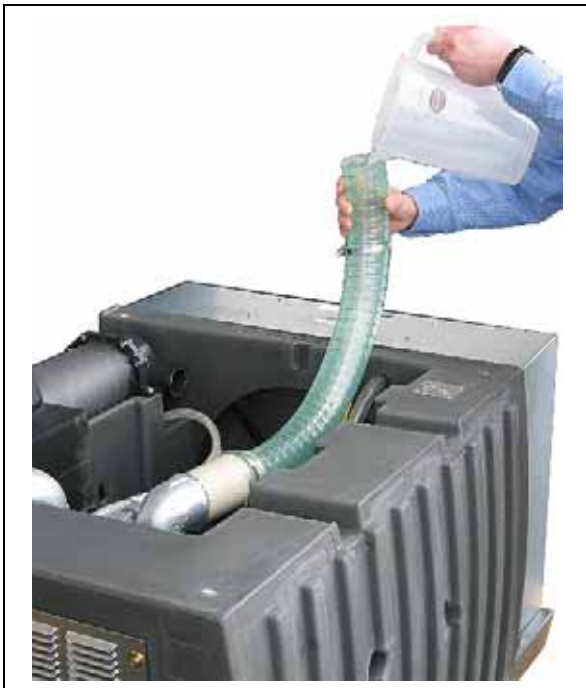
Fig. 14: Korrosionsschutzmittel in eingebautes Aggregat einfüllen (für Typen 2BL2 251 - 2BL2 341)
