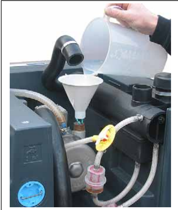
Fig. 13: Korrosionsschutzmittel in eingebautes Aggregat einfüllen (für Typen 2BL2 041 - 2BL2 141)
