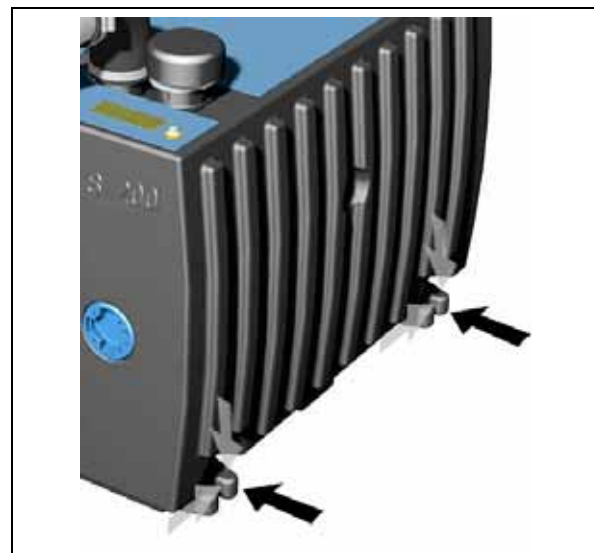
Fig. 4: Stellen zum Messen der Schwinggeschwindigkeit
