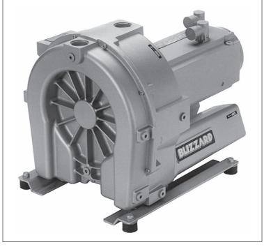
Laufrad. Dieses Laufrad ist "fliegend" auf dem ins Gehäuse integrierten Motor angeordnet. Die Kühlung erfolgt über zwei getrennte Kühlwasserkreisläufe für Gebläse und Motor. Die Ein- und Auslassseite ist mit je einem Anschlussadapter bestückt.
