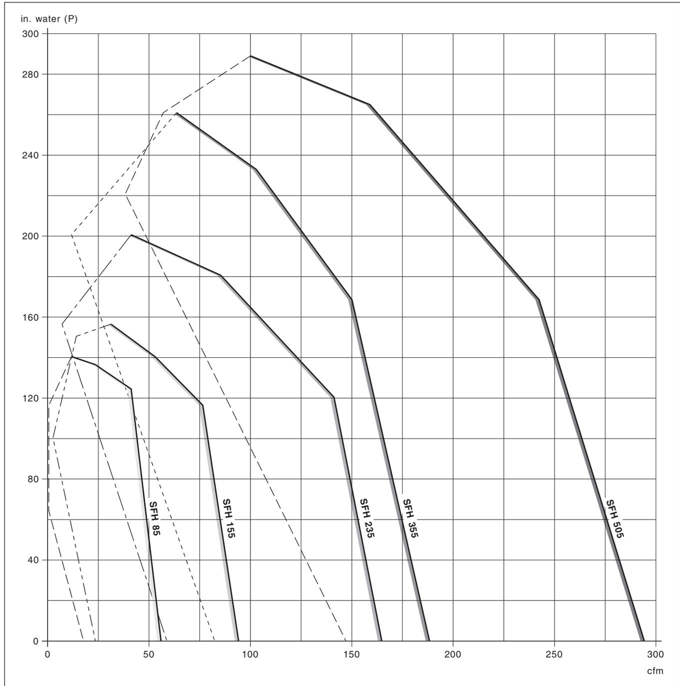
Curves have a tolerance of ± 10 % and refer to free air at 1 standard atmosphere and 20° C (68° F)./ Las curvas tienen una tolerancia de ± 10 % y se refieren al aire libre a 1 atmosfera estándar de presión y a 20° C (68° F) de temperatura./ Les courbes ont une tolérance de ± 10 % et sont établies à l'atmosphère de 1 bar (abs.) à 20° C (68° F)./ As curvas têm uma tolerância de ± 10 % referem-se ao ar livre a uma atmosfera padrão 1 e a 20° C (68° F).
