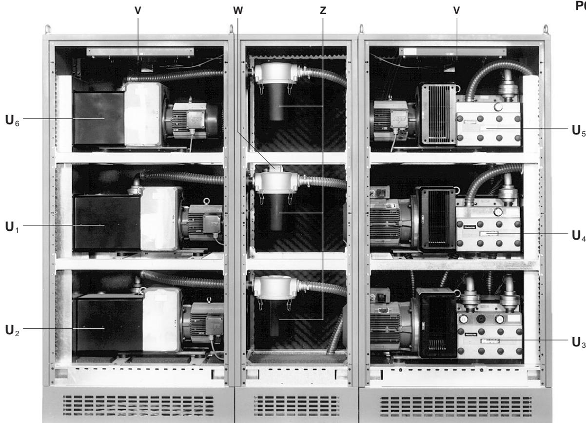
V → Dachlüfter (siehe auch Datenblatt Z 14/3) • W → Sicherheitsthermostat • Z → Vakuumdichter Staubabscheider (ZFP 216 (07))
