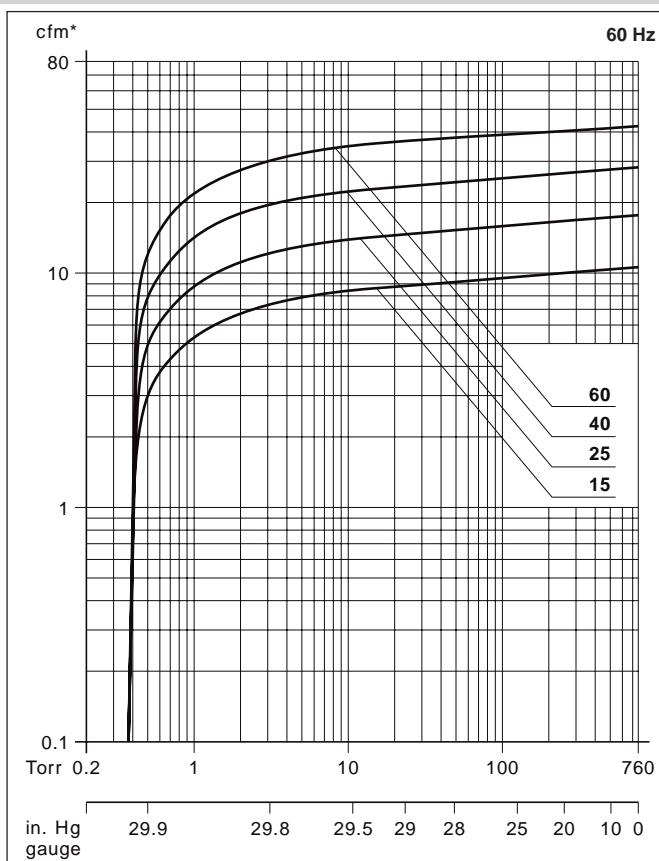
\* Relates to pump inlet conditions./ se refiere a las condiciones de entrada de la bomba./ relativ à l'état régnant à l'aspiration./ refere-se a condições de entrada da bomba.
